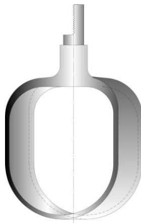
Рисунок 1а – Фаршемешалка механизма ВМ
